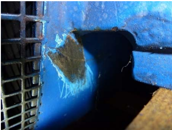
Abb. 4: Riss im Statorgehäuse
