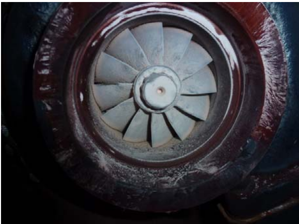
Abb. 25: Ablagerungen am Abgasturbolader
