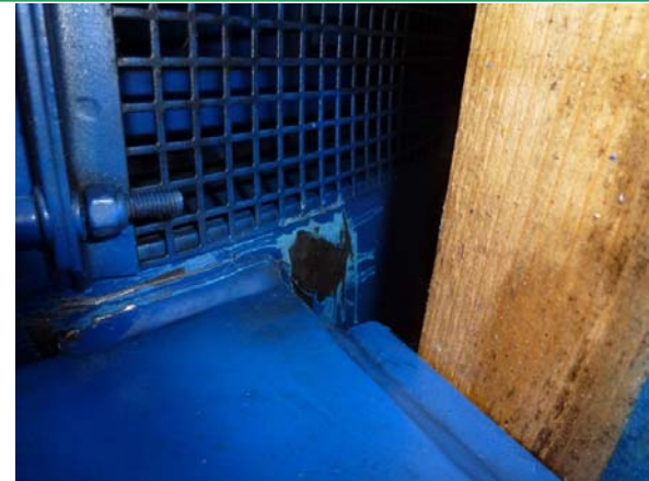
Abb. 6: Riss im Statorgehäuse
