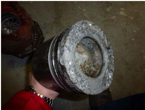
Abb. 15: thermisch überlasteter Kolben
