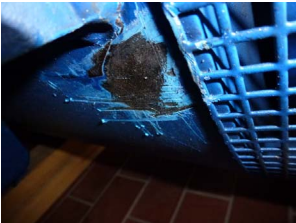
Abb. 5: Riss im Statorgehäuse
